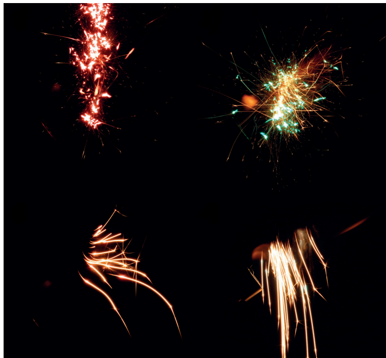
Langzeitaufnahmen von Funken seltener Erdmetalle nach Entzündung in einer Brennerflamme. Oben links Samarium, rechts Thulium; unten links Yttrium, rechts Lutetium.
